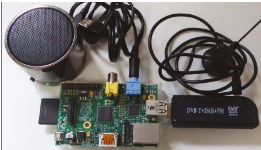
Rysunek 1: Konfiguracja sprzętowa radia FM.
