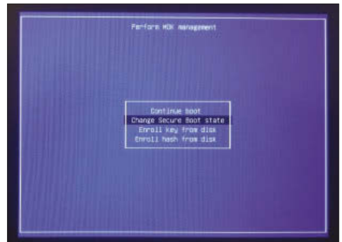
Rysunek 3: Szybko i niebezpiecznie: Shim umożliwia wyłączenie weryfikacji cyfrowych podpisów.
